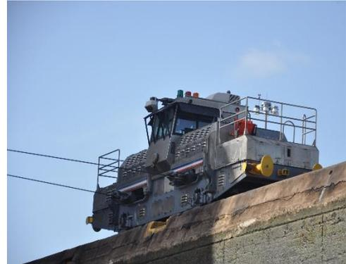
allerdings mit Stahlseilen mittels derer sie von jeweils vier Elektrolokomotiven durch die Schleusenkammern gezogen werden. Hier ist Präzisionsarbeit gefragt, denn viele Schiffe sind genau auf das „Panamax“ Maß zugeschnitten, da bleibt rechts und links gerade noch ein halber Meter Raum frei...
